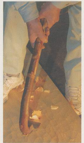
新／削ぎ取るように木肌表面を叩き削る大工道具で、古くは刃型が湾曲している形状から蛤刃とも言われている。鱗模様のように仕上げるためには、均一な力でリズムカルに叩き続ける技術が要求される。
