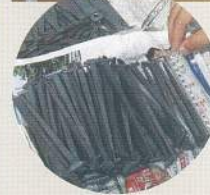
焼印を押す／再利用した部材と、今回の修復時に取替・補足した部材を区別するため、修理年号を記した焼印を押しておく。
